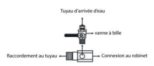
Selon les séries, il vous est mis à disposition un raccord rapide pour robinet (type machine à laver) de diamètre G3/4.
